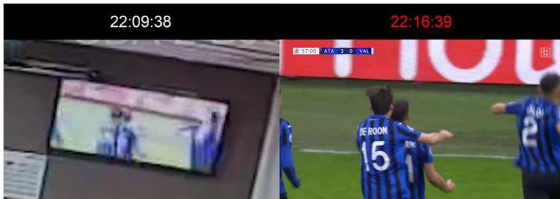
Abb. 3: Video B (rechts) wird mit dem Videomaterial der Überwachungskamera synchronisiert, indem einzelne Bewegungen der Spieler nach einem Tor erfasst werden. Über Video B wird die Realzeit angezeigt, welche durch die Audiosynchronisation mit Video A bestimmt wurde. Oben links wird die Zeit der Überwachungskamera in dem Moment angezeigt. Die Differenz zwischen den beiden Zeiten beträgt 7 Minuten und 1 Sekunde.
